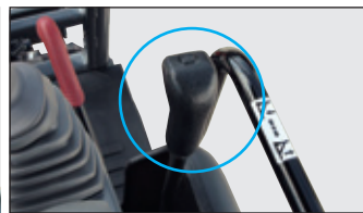
Planierschildhebel mit 2-stufigem Fahrstufenschalter
