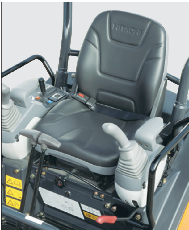
Planierschildhebel mit 2-stufigem Fahrstufenschalter
