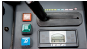
Planierschildhebel mit 2-stufigem Fahrstufenschalter
