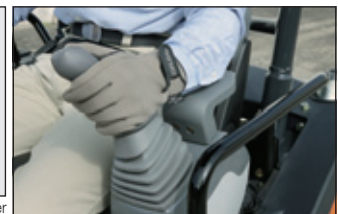
Planierschildhebel mit 2-stufigem Fahrstufenschalter
